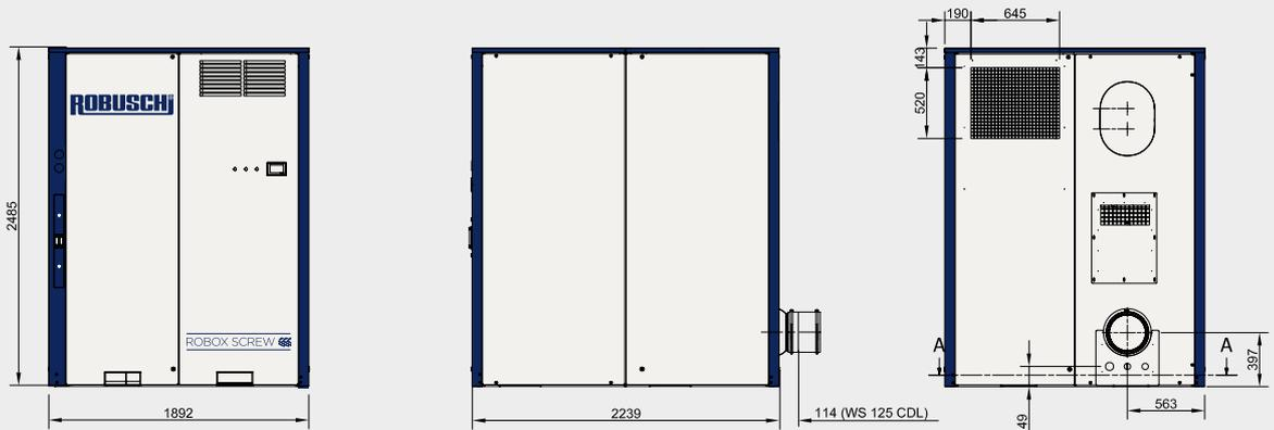
WS Version mit Schallschutzhaube - WL Version ohne Schallschutzhaube
