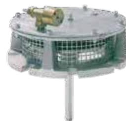
La soupape VSM est également munie d'une vanne pilotée PSM spéciale, montée sur le couvercle, qui lui permet de faire aussi office de soupape de décharge en pression, avec une surpression maximale de 5 % inférieure à celle de réglage.
