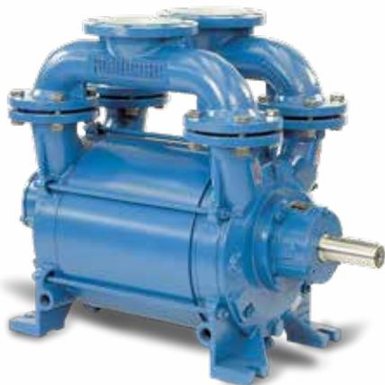
La serie **RVS** sono pompe ad anello liquido con caratteristiche innovative, in grado di raggiungere un grado di vuoto fino a 33 mbar (a) e portate fino a 4200 m<sup>3</sup>/h, di aspirare gas e vapori, priva di contaminazione da lubrificanti; anche in presenza di liquido trascinato e con compressione dei gas praticamente isotermica.
