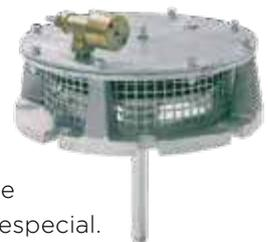
La válvula VSM también está equipada con una válvula piloto PSM especial montada en la tapa, que también la hace funcionar como válvula de descarga en presión, con una sobrepresión máxima un 5 % inferior al valor de la presión de ajuste.
