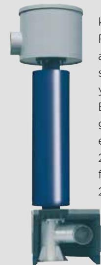
Kit específico para paquetes Robox en funcionamiento al vacío, compuesto por silenciadores de absorción SDL y silenciadores de escape SPS. Esto reduce el nivel sonoro generado por la salida del escape en aproximadamente 25 dB(A) dentro del campo de frecuencia que va de 200 Hz a 20 kHz.
