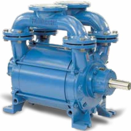
Die **RVS**-Baureihe sind Flüssigkeitsringpumpen mit innovativen Eigenschaften. Sie können einen Vakuumgrad bis zu 33 mbar(a) und Fördermengen bis zu 4200 m<sup>3</sup>/h erreichen und Gas und Dämpfe ohne Verunreinigung durch Schmiermittel aufsaugen; auch bei Vorhandensein von mitgeförderter Flüssigkeit und mit praktisch isothermischer Kompression der Gase.
